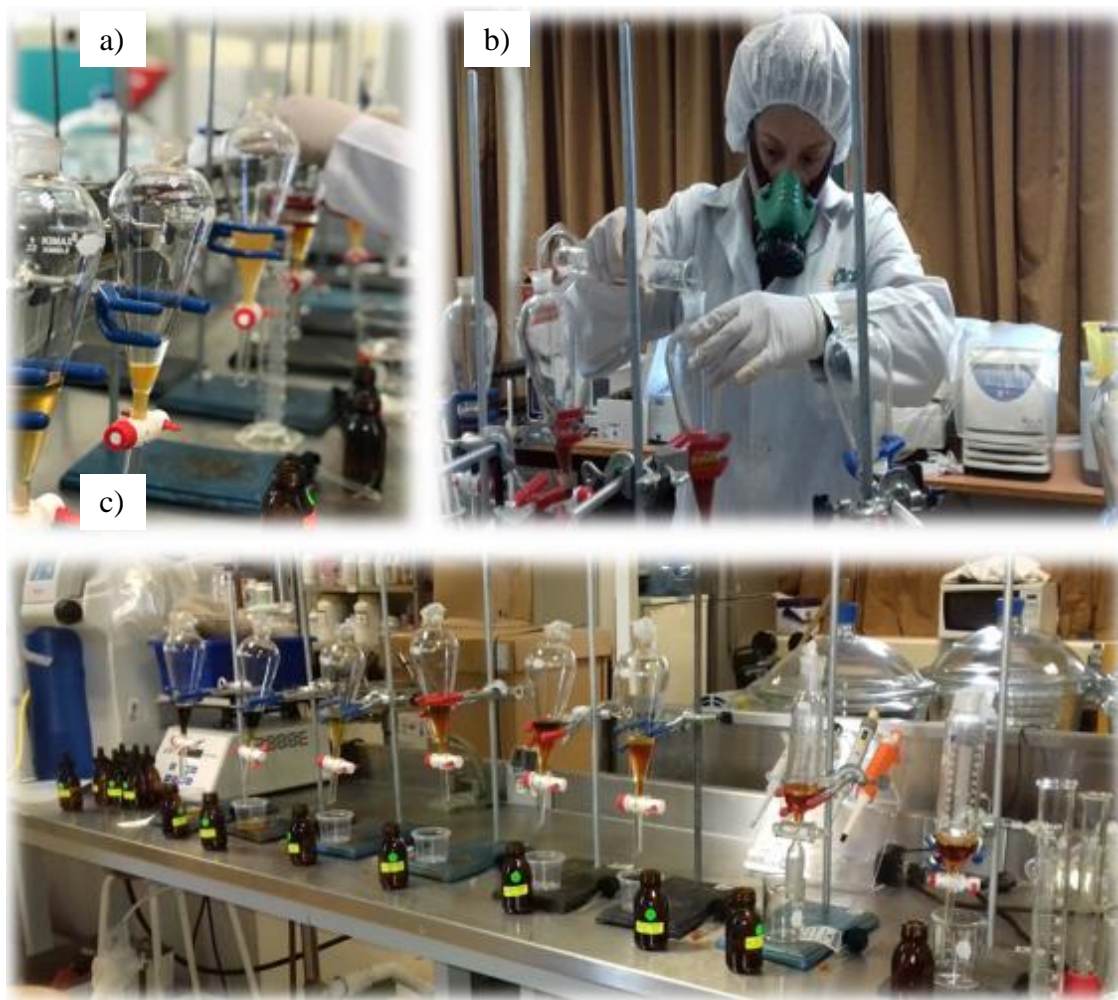
Figura 8. Determinación de fenoles totales y saponinas por el método de separación con solventes
