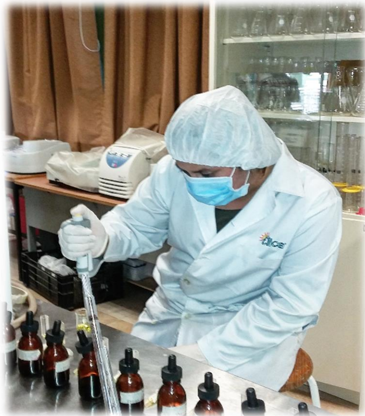
Figura 6. Determinación de fenoles totales por el método de Folin-Ciocalteu
